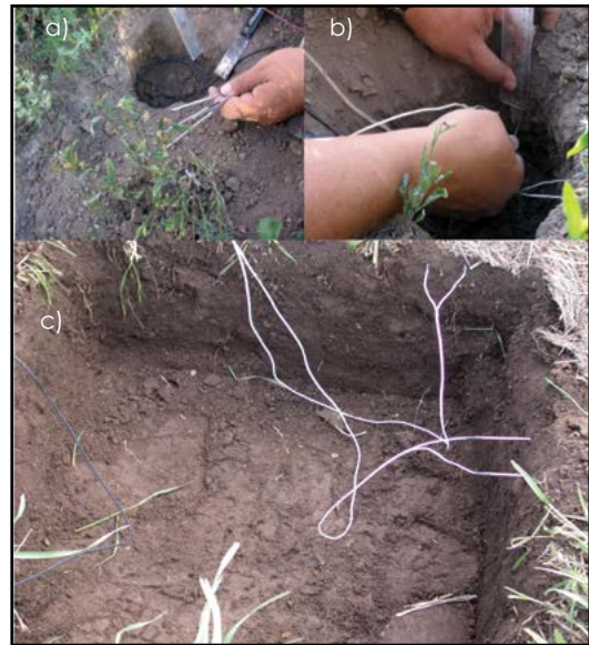
Figura 6. Instalación de termopares para medir temperatura del suelo en la superficie hasta 8 cm de profundidad (a, b) y en el perfil a mayor profundidad (c).
