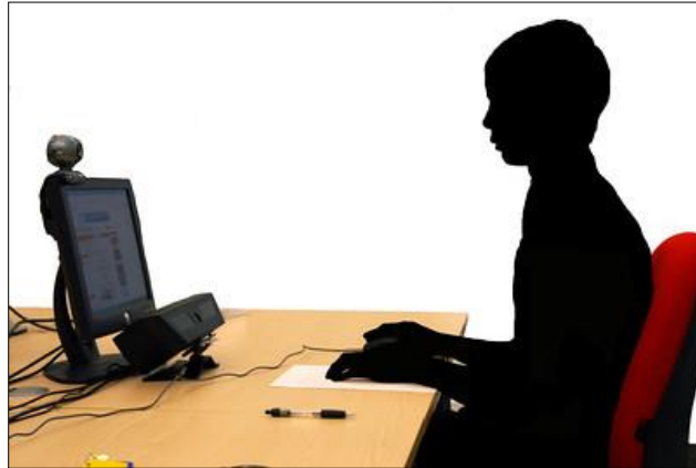
Figura 1. Ejemplo de un estudio de rastreo visual. Se presenta información al participante en un monitor. Mientras el participante realiza una tarea con la información presentada, se rastrea la mirada del participante mediante cámaras y sensores [Imagen de estudio de rastreo visual]. Recuperado de City University Interaction Lab. (28 de enero de 2010).
