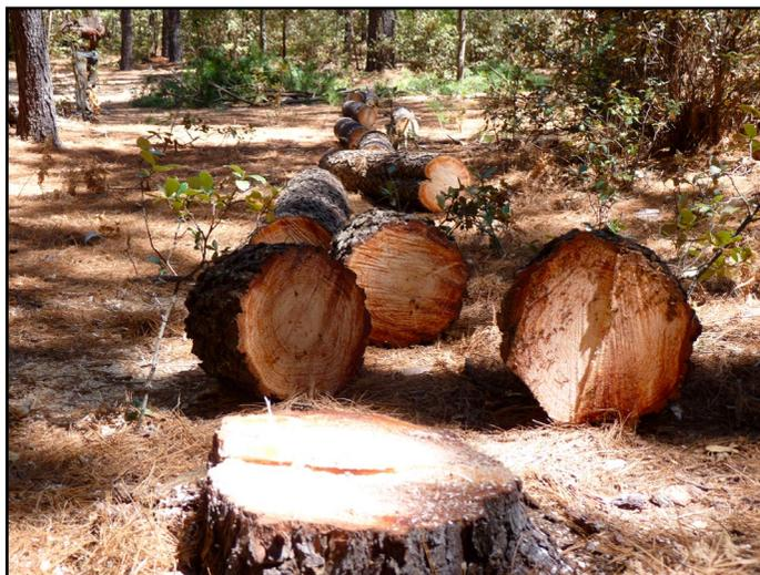
Figura 2. Toma de datos de campo. Una vez derribado el árbol el fuste se secciona para obtener dos piezas de 0.30 m por encima del tocón y una a la altura del diámetro normal (1.30 m). Las siguientes secciones tienen una longitud de 2.44; excepto la punta del árbol, de longitud variable. Fotografía de Benedicto Vargas-Larreta.
