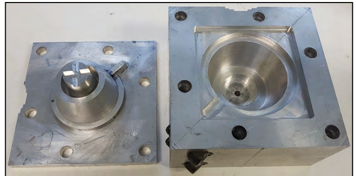
Figura 6. Molde de dos piezas para el cuerpo de la alcantarilla. Fotografía tomada por el equipo de investigación.
