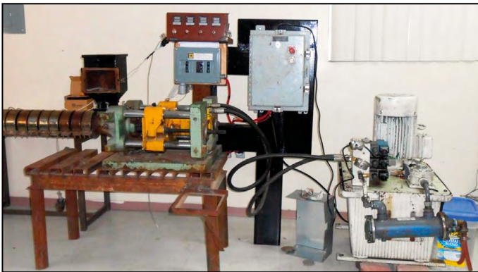
Figura 2. Extrusor monohusillo. Fotografía tomada por el equipo de investigación.
