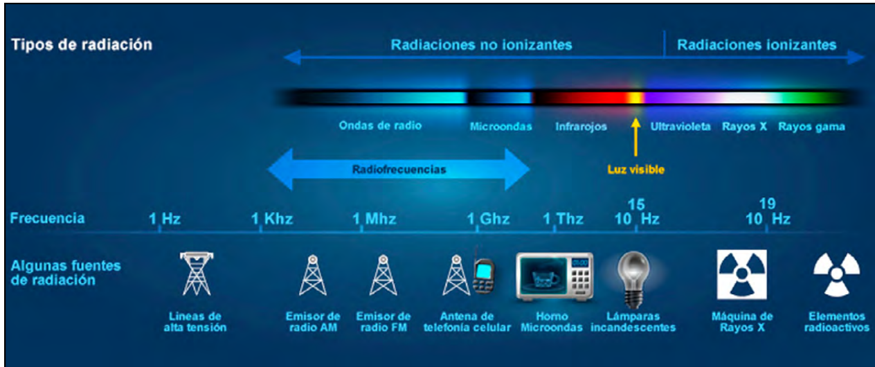
Figura 2. Esquema ilustrativo de fuentes de radiación conocidas y su relación con la frecuencia en el campo electromagnético. Imagen tomada de Organización Mundial de la Salud (s. f.).
