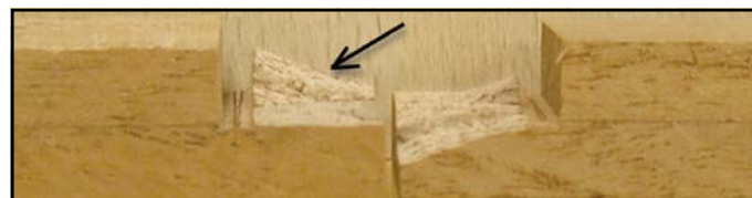
Figura 4. Secciones de la probeta de P. laevigata después de la prueba de cizallamiento. La flecha señala la sección de la madera que sufrió el desgarramiento de las fibras.
