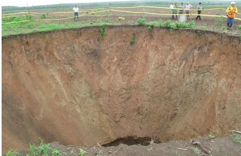
Figura 6. Foto evidencia de una dolina de colapso-disolución de reciente formación en Hopelchén, Campeche. Fotografía tomada por Álvaro Gerardo Palacio Aponte.
