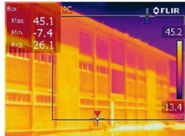
Figura 2. Lectura termográfica la fachada Sur del edificio.
