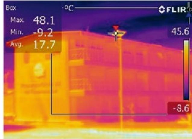
Figura 1. Lectura termográfica la fachada Norte del edificio.
