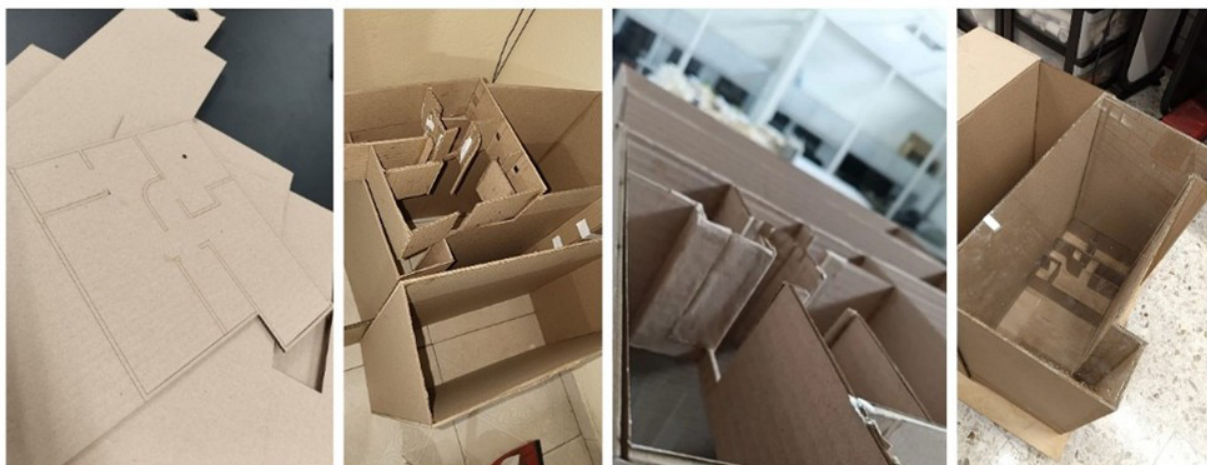
Figura 3. Detalles de la construcción del modelo físico a escala. a) corte de las piezas en cartón, b) armado del modelo, c) pegado de las paredes, d) modelo físico.
