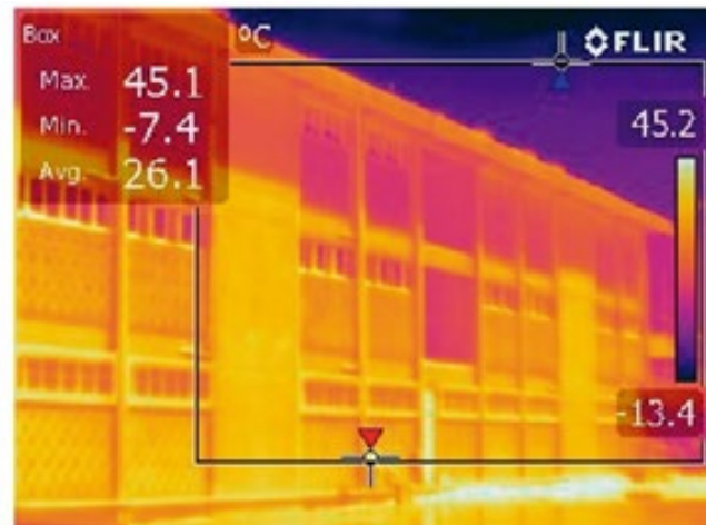
Figura 2. Lectura termográfica la fachada Sur del edificio.
