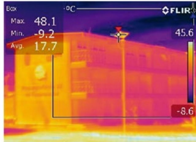
Figura 1. Lectura termográfica la fachada Norte del edificio.
